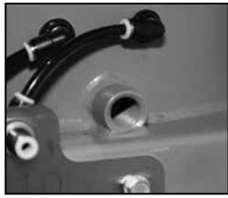
Fan Drain Connection
